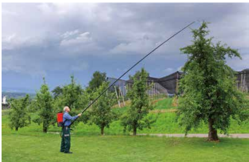
Teleskoplanze für den gezielten Einsatz an hohen Pflanzen
